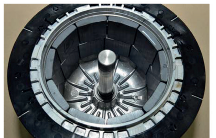
Rotor z hliníkového tlakového odlitku s umělohmotnou deskou (není znázorněna) na prstenci
